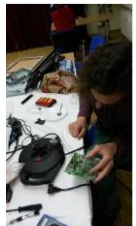
Ein kaputter Flachbildschirm wurde zerlegt und als Ursache des Defekts konnten aufgeblähte [Elektrolytkondensatoren](#) ausgemacht werden - denen war es wohl zu warm geworden. Wenn die Ersatzteile beschafft sind, wird er wieder zusammengebaut.
