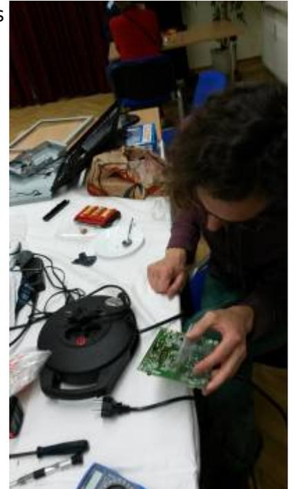
Eine Abiturientin brauchte Hilfe bei einem Notebook, an dem die Ladebuchse nicht mehr funktionierte. Nach dem Zerlegen wurde die verschmorte Buchse ausgelötet und wenn sie das nächste Mal mit dem Ersatzteil vorbeikommt, bauen wir das Teil wieder zusammen.
