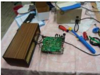
Ein Radio aus DDR-Produktion unterhielt seine Zuhörer zuweilen nur noch flüsternd. Während einer ausgiebigen Fehlersuche löteten wir viele komisch aussehende Lötstellen nach. Letztendlich fanden wir durch die „einkreisende Klopfmethode“ heraus, dass ein Kondensator schlecht montiert war. Der Anschlussdraht schaute kaum durch die Leiterplatte hindurch, weshalb er keinen guten Kontakt mit der Lötstelle hatte. Wir änderten das und sogleich ertönte das Radio wieder in voller Pracht.
