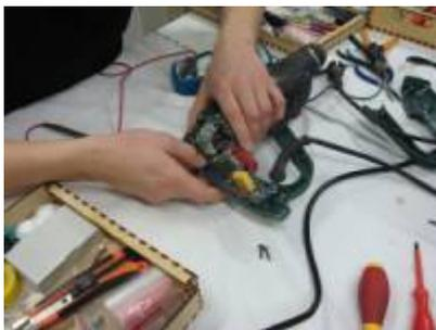
Ein Bohrhämmer „ParkSide PBH 1100 A1“ wollte nicht mehr zuverlässig bohren und hämmern. Wir konnten relativ schnell einen Kabelbruch an der Gehäuseeinführung feststellen. Wir schnitten das defekte Stück ab und schlossen das Kabel wieder neu an. Nun hilft der Bohrhämmer seinem Besitzer wieder zuverlässig.
