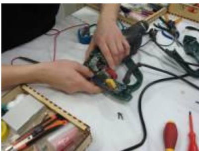
Ein ParkSide „PBH 1100 A1“ Bohrhämmer wollte nicht mehr zuverlässig bohren und hämmern. Wir konnten relativ schnell einen Kabelbruch an der Gehäuseeinführung feststellen. Wir schnitten das defekte Stück ab und schlossen das Kabel wieder neu an. Nun hilft der Bohrhämmer seinem Besitzer wieder zuverlässig.
