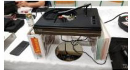
Ein [RFT "P 1229"](#) Plattenspieler schaltete sich nicht mehr richtig ein und aus. Wir mussten erst einmal untersuchen, wie das Gerät überhaupt aufgebaut ist und funktionieren soll. Dann bemerkten wir, dass der Gummi des Antriebsrades hart geworden und schmutzig war. Wir reinigten das Rad, rauten es etwas auf und justierten den Abschalthebel neu. Damit funktionierte es wieder.
