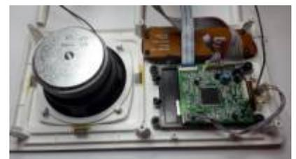
Beim Mikro-HiFi-System „Sony CMP-HP7“ bewegte sich CD-Fach nicht mehr, es klemmte. Wir bauten den Wechsler aus und tauschten 3 Antriebsriemen. Nach Funktionsprobe bewegte sich das Laufwerk und Abspielen war möglich. Anschließend erkannte er aber nicht mehr, wenn keine CD im Fach lag und versuchte diese auszuwerfen, zeigte „Error“ an. Das untersuchten wir beim nächsten RC weiter.
