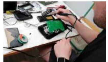
Der nächste Aktenvernichter „Hama Premium X6 Shredder“ zeigte gar keine Funktion mehr. Bei genauem Hinsehen konnte man feststellen, dass das Betätigungsblech für Sicherungsschalter am Fangkorb verbogen und teilweise lose war. Wir bohrten durch den Blechwinkel ein Loch und befestigten
