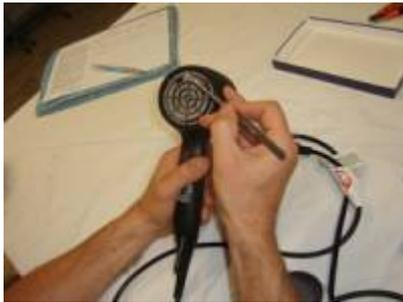
Ein „RCY 91-M“ Haartrockner schaltete sich immer nach wenigen Minuten Benutzung einfach ab und ging auch nicht gleich wieder an. Nachdem wir die Abdeckung der Luftzufuhr abgenommen hatten, sahen wir, dass der Föhn stark verschmutzt war und nicht mehr genug Luft an der Heizung vorbeiblies. Dadurch wurde das Gerät zu heiß und der Thermoschalter schützte es vor Überhitzung. Wir reinigten das Teil von all den Flusen und Haaren und danach pustete er wieder kräftig und dauerhaft.
