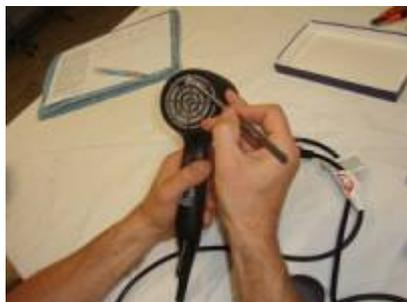
Ein Haartrockner „RCY 91-M“ schaltete sich immer nach wenigen Minuten Benutzung einfach ab und ging auch nicht gleich wieder an. Nachdem wir die Abdeckung der Luftzufuhr abgenommen hatten, sahen wir, dass der Föhn stark verschmutzt war und nicht mehr genug Luft an der Heizung vorbei blies. Dadurch wurde das Gerät zu heiß und der Thermoschalter schützte es vor Überhitzung. Wir reinigten das Teil von all den Flusen und Haaren, danach pustete er wieder kräftig und dauerhaft.
