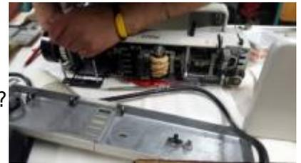
Eine weitere Nähmaschine „Pfaff 1212“ lief nur noch sehr schwergängig und der Motor rauchte nach kurzer Zeit. Wir reinigten und schmierten die Mechanik und so wurde die Maschine wieder deutlich beweglicher. Allerdings war Motor wohl nachhaltig beschädigt, denn er rauchte auch ohne Last. Der Gast wird sich um einen Ersatzmotor bemühen und wiederkommen.
