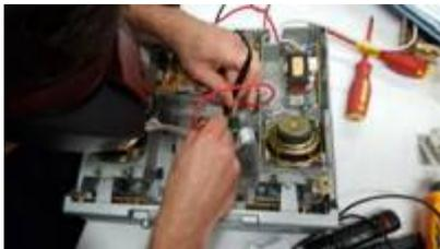
Das Sony „ICF-CD543 RM“ Unterbauradio beschäftigte uns den ganzen Abend. Zum Glück haben wir Helfer „mit langem Atem“. Bei uns war es, weil der CD-Schacht nicht mehr reagierte. Bei eingehender Fehlersuche fanden wir heraus, dass die 6-Volt-Spannungsversorgung des Liftermotors fehlte. Wir fanden nach einiger Zeit einen defekten Widerstand und [Elektrolytkondensator](#). Nach dem Austausch funktionierte das Gerät wieder.
