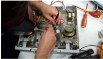
Das Unterbauradio „Sony ICF-CD543 RM“ beschäftigte uns den ganzen Abend. Zum Glück haben wir Helfer „mit langem Atem“. Bei uns war es, weil der CD-Schacht nicht mehr reagierte. Bei eingehender Fehlersuche fanden wir heraus, dass die 6-Volt-Spannungsversorgung des Liftermotors fehlte. Wir fanden nach einiger Zeit einen defekten Widerstand und [Elektrolytkondensator](#). Nach dem Austausch
