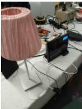
Eine Minikompaktanlage „Sony HCD-H901AV“ funktioniert zwar, wollte aber absolut keine CD erkennen. Nach der Reinigung der Optik mit [Isopropanol](#) war dieser Fehler behoben.
