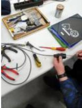
Der Staubsauger „Hoover Model CP70 CP40011“ kam seiner Aufgabe nicht mehr nach, er funktionierte plötzlich nicht mehr. Wir testeten das Gerät und sahen am Stecker schon ein etwas abgeknicktes Kabel. Beim kräftigen Wackeln und Drücken an der Stelle, sprang der Motor kurzzeitig an, ein Wackelkontakt also. Wir schnitten den Stecker und etwas Kabel ab und montierten einen neuen Konturenstecker. Nun saugt er wieder zuverlässig.
