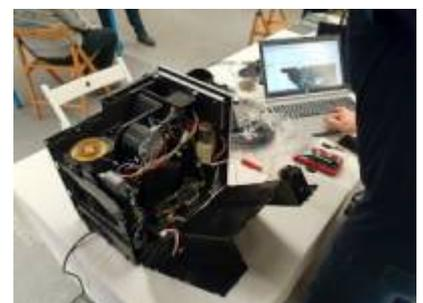
Der Farblaserdrucker „HP Color Laser Jet CP1217“ verzierte die Ausdrücke mit zusätzlichen Streifen, die sich der Besitzer nicht mehr bieten lassen sollte. Wir untersuchten die Trommel und Fixiereinheit, die sahen passable aus. Allerdings hatten die Farbkartuschen einige Beschädigungen und waren stark
