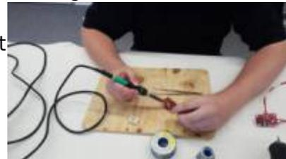
Zu Beginn halfen wir einem Besucher, eine seiner Solar-Laderegler-Platinen wieder in den Originalzustand zu versetzen. Es fehlte ein Bauteil, das beim Basteln mit der Platine verloren gegangen war. Anhand einer zweiten, vollständigen Platine konnten wir das Bauteil identifizieren. Zum Glück hatten wir den fehlenden [SMD-Tantal-Elko](#) da und konnten ihn gleich ergänzen. Der Besitzer war froh, das Problem so einfach und schnell gelöst zu haben.
