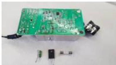
Ein Drucker „HP Officejet 6500“ funktionierte nicht mehr. die Ursache war leicht zu finden. Die grüne [LED](#) am externen Netzteil leuchtete nicht mehr und es gab keine Spannung aus. Wir untersuchten das Netzteil und fanden gleich einen explodierten [SMD-Widerstand](#) vor.
