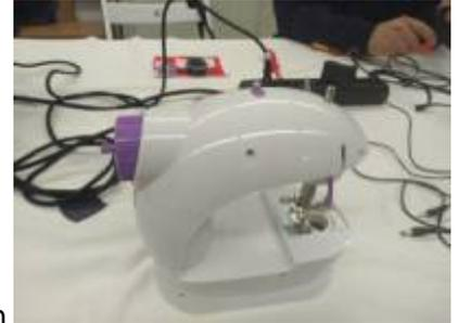
Sehr lange hat uns eine Mini-Nähmaschine „Sewing SM-202A“ beschäftigt. Sie nähte nicht mehr. Irgendwie hat es hier mal richtig gerammelt, denn die Nadel tauchte ins Schiffchen an der ganz falschen Stelle ein. Dort konnte der Greifer den Faden nicht aufnehmen. Hier war einiges verstellt; die Nadel war auch verbogen. Wir haben zwar einiges wieder an die richtige Stelle bekommen, aber genäht hat sie trotzdem noch nicht. Das nächste Mal geht es weiter.
