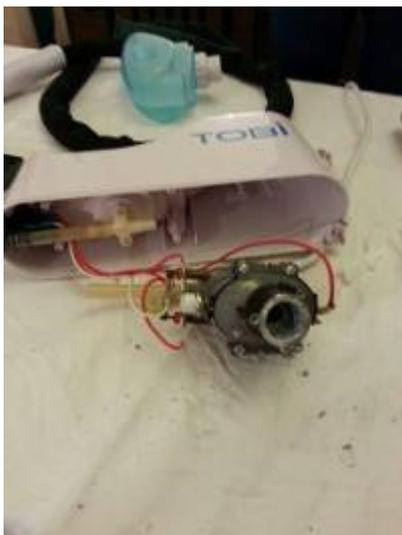
Bei einem Dampfbügler wurde zwar alles heiß, aber dampfen wollte er nicht. Wir haben das Gerät komplett zerlegt – alles total verkalkt! Damit reichte die erzeugte Wärme nicht mehr, um das Wasser zu verdampfen. Die Besitzerin hat das Gerät so demontiert mitgenommen und behandelt es zu Hause mit Entkalker. Wir sehen uns also bald wieder.
