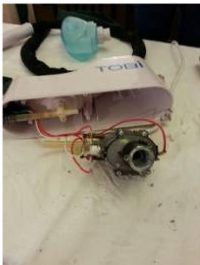
Bei einem Dampfbügler wurde zwar alles heiß, aber dampfen wollte er nicht. Wir haben das Gerät komplett zerlegt – alles total verkalkt! Damit reicht die erzeugte Wärme nicht mehr, um das Wasser zu verdampfen. Die Besitzerin hat das Gerät so demontiert mitgenommen und behandelt es zu Hause mit Entkalker. Wir sehen uns also bald wieder.
