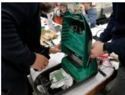
Der Staubsauger „Miele Calypso Typ S 252i“ zeigte nach 30 Jahren keine Regung mehr. Wir fanden einen defekten Einschalter, der starker Kontaktabbund hatte, eine Motorkohle fehlte und deren Kohlenhalter war beschädigt. Eine Reparatur wäre sehr aufwändig und lohnt sich wirtschaftlich nicht.
