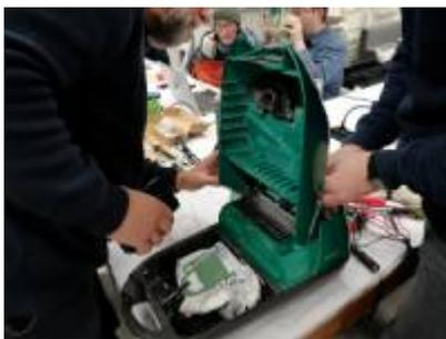
Der Staubsauger „Miele Calypso Typ S 252i“ zeigte nach 30 Jahren keine Regung mehr. Wir fanden einen defekten Einschalter, der starker Kontaktabbbrand hatte, eine Motorkohle fehlte und deren Kohlenhalter war beschädigt. Eine Reparatur wäre sehr aufwändig und lohnt sich wirtschaftlich nicht.
