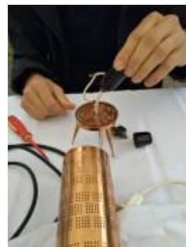
Eine etwa 60 Jahre alte Nachttischleuchte aus reinem Kupfer hatte einen zerstörten Einschalter und ein inzwischen nicht mehr zulässiges Anschlusskabel. Die Besitzerin konnte mit unserer Hilfe ein modernes und sicheres Schuko-Anschlusskabel montieren. Der Schalter war leider nicht mehr zu retten, daher wird Schaltfunktion eine Funksteckdose übernehmen. Damit ist die Lampe dann sogar fernbedienbar.
