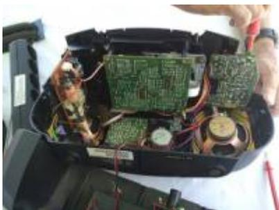
Ein CD-Radiorekorder „AZ1005“ von Philips sagte in keiner Position des Quellenschalters etwas. Auch das Display blieb dunkel. Bei der Diagnose blieben wir dann genau an diesem Quellenschalter hängen. Nach dem Ausbau und der Reinigung konnten wir dann wieder einen genügend kleinen Übergangswiderstand an den Kontakten messen. Zur Freude des Besitzers funktionierten dann das Radio und auch der CD-Player wieder.
