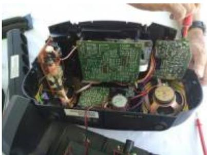
Ein „AZ1005“ CD-Radiorekorder von Philips sagte in keiner Position des Quellenschalters etwas. Auch das Display blieb dunkel. Bei der Diagnose blieben wir dann genau an diesem Quellenschalter hängen. Nach dem Ausbau und der Reinigung konnten wir dann wieder einen genügend kleinen Übergangswiderstand an den Kontakten messen. Zur Freude des Besitzers funktionierten dann das Radio und auch der CD-Player wieder.
