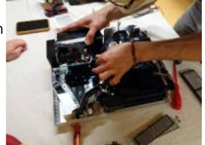
Zwei Mundduschen „Panasonic EW 1211W“ wurden mit unterschiedlichen Defekten gebracht. Bei einer war der Akku defekt und bei der anderen ging die Pumpe nicht mehr. Wir bauten die Pumpe aus dem einen in das andere Gerät und machten so aus zwei defekten ein funktionierendes.
