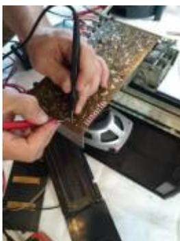
Eine „LAMPETTE“ Design-Lampe musste repariert und ein bisschen dem heutigen Sicherheitsstandard angepasst werden. Dazu wurde die Trafo-Verkabelung erneuert und auch der Bananen-Anschlussstecker gegen einen Eurostecker getauscht.
