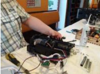
Nach einem auffällig ruhigen Start erreichte uns wieder einmal ein Toaster. Wie immer war auch hier die Heizwendel (aus einer Art Aluminiumdraht) an der schwächsten Stelle durchgeglüht. Eine Reparatur ist aufgrund des Aufbaus der Heizelemente (spröde [Glimmerplatten](#)) nicht möglich.
