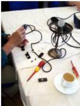
Eine LED-Unterbauleuchte mit Bewegungsmelder funktionierte nur noch unzuverlässig. Wir prüften die Steckverbindung und fanden dort eine Kontaktunsicherheit. Wir reparierten den Stecker und dann funktionierte die Leuchte wieder sehr gut.
