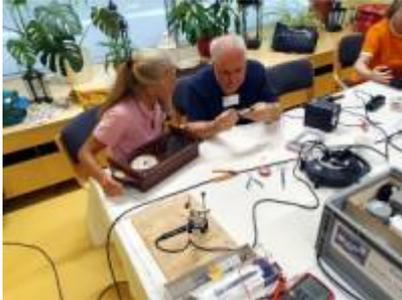
Los ging es mit einer 50 Jahre alten Nähmaschine „Veritas Nutznaht Automatik“ bei der ein Hebel abgebrochen war und die Aufspulautomatik nicht mehr funktionierte. Ein neuer Hebel wurde eingebaut, die Aufspulautomatik neu eingestellt und der Elt-Anschluss des Motors wieder mit einer Schraube komplettiert. Zum Schluss wurde dann alles noch grob gereinigt und geölt .... auf in die nächsten „...zig“ Jahre.
