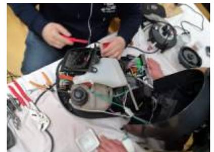
Das CD-Kompaktradio „SonicStorage CMT-A50“ funktionierte zwar, aber im Display wurde nichts angezeigt - die Hintergrundbeleuchtung ging aber. Wir haben das Gerät demontiert und eine beschädigte Leiterplatte vorgefunden - wie durch einen ausgelaufenen Kondensator. Diese waren aber in der Umgebung alle in Ordnung - wir haben hier abgebrochen. Eine Teilnutzung ohne Anzeige ist aber weiterhin möglich.
