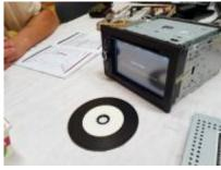
Nun war das Autoradio/Navi "VNG30WS" an der Reihe. Eine eingelegte CD wurde nicht mehr ausgeworfen. Abhilfe brachte dem Besitzer das Gerät zu zerlegen und die CD direkt aus dem Laufwerk zu entnehmen. Bei der "verschluckten" CD handelte es sich um eine Sonderedition, die einer Schallplatte nachempfunden ist. Der anschließende Test mit einer Standard-CD zeigte: das Gerät funktioniert einwandfrei, die CD war wohl zu speziell.
