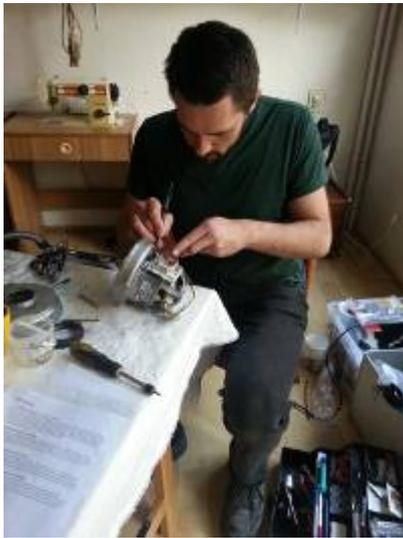
An dem Staubsauger eines deutschen Markenherstellers wurde ein Lüftermotor mit Dauerstillstand festgestellt. Der Motor haben wir komplett freigelegt und dabei bemerkt, dass der Statorkorb verzogen war - leider irreparabel. Allerdings konnten wir noch den Tipp geben, auf einem Wertstoffhof nach einem vergleichbaren Gerät zu fragen um kostengünstig an einen Austauschmotor zu kommen.
