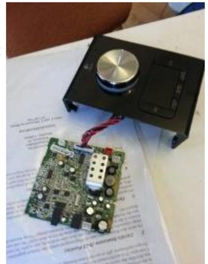
Bei einem WLAN-Funkradio konnte nur noch ein irreparabler Schaden festgestellt werden. Vermutlich war das externe Steckernetzteil defekt und hat die interne Leiterplatte gegrillt, sie war bereits stark verschmort.
