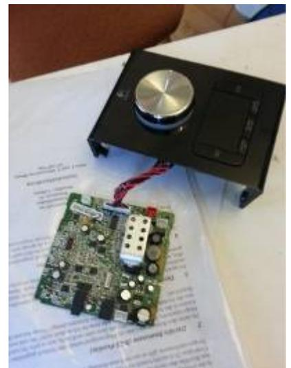
Bei einer Spielkonsole konnte die Funktion aufgrund eines tiefentladenen Li-Ion-Akkus nicht getestet werden. Ein Ladegerät mit amerikanischer Norm (110V/60Hz) konnte mangels Trafo nicht getestet werden und das zweite Netzteil gab kein Lebenszeichen mehr von sich. Da es nicht zerstörungsfrei zerlegt werden konnte, ließen wir es lieber ungeöffnet.
