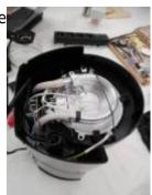
Für eine tiefgreifende Fehlersuche an einem 3D-Drucker "MakerBot Replicator" (5. Generation) fehlte uns dann allerdings die Zeit. Nach Angabe des Besitzers startet er sporadisch nicht, was er aber bei uns hier immer machte. Optisch konnten wir im Netzteil erstmal keine defekten auch Elkos entdecken; da bleibt nur: beobachten und für das nächste Mal mehr Zeit einplanen.
