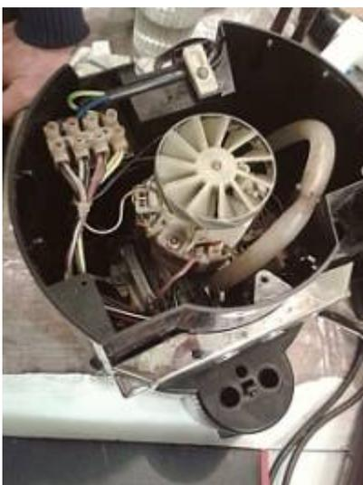
Im Falle einer Bosch Espressomaschine, die nach einer Fehlfunktion nicht wieder einzuschalten ging, hatten wir dagegen mehr Glück. Nach längerer Suche mit dem Multimeter stellte sich heraus, dass eine Kontaktfeder für die [Bürstenkohle](#) des eingebauten Elektromotors durch Wasserkontakt
