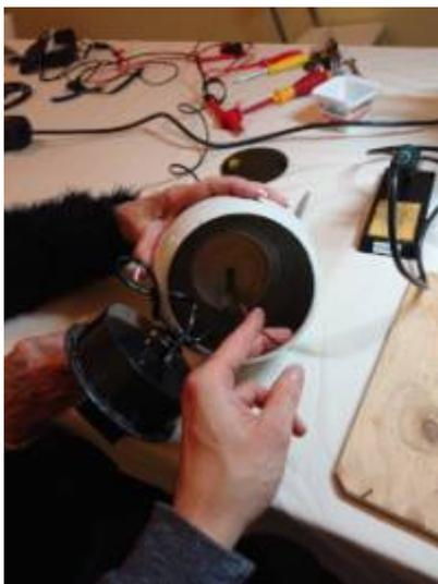
Auch bei dem Wasserkocher „First Austria FA-5406-2“ passierte nichts mehr. Die Kontakte waren in Ordnung und auch die Heizung war OK. Hier war nach 4 Jahren schon der Schalter defekt. Der Besucher hatte mit der aufgedruckten Beschriftung etwas im Internet gefunden und wird einen neuen Schalter besorgen.
