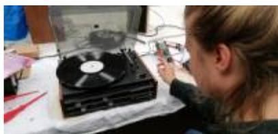
Ein Plattenspieler „Ziphona Türkis 524“ konnte nicht mehr funktionieren, weil seine Netzsicherung immer beim Einschalten durchbrannte. Hier lag es an einem defekten Entstörkondensator „47 nF 250VAC“, der einen Kurzschluss hatte. Nach Austausch des Teils funktionierte wieder alles bestens und die Besucherin war sehr froh, ihre Weihnachtsplatten wieder wie jedes Jahr abspielen zu können.
