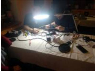
Eine Tischlampe „Trio 2x20W 12V“ hatte noch mal kurz geflackert und ging dann nicht mehr an. Die Diagnose hat einen Fehler in der Geräteverdrahtung gezeigt. An der Fassung war ein Wackelkontakt und im flexiblen Lampenhals verhinderte zusätzlich ein Kabelbruch die Funktion. Da wir den nicht einzeln reparieren konnten, haben wir die gesamte Kleinspannungsverdrahtung entfernt und alles neu gemacht.
