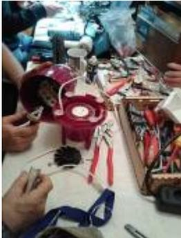
Bei einem SilverCrest „SSM 550 D1“ Standmixer tat sich auf einmal nichts mehr, weshalb der Besitzer ihn zu uns ins RepairCafé brachte. Wir fanden darin eine durchgebrannte Feinsicherung in der Zuleitung zum Motor vor, für die wir allerdings keinen passenden Ersatz vorrätig hatten. Der Gast muss hierfür also zunächst eine neue Sicherung besorgen und für den Austausch zu einem späteren Termin wiederkommen.
