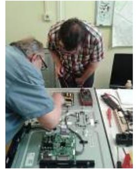
Ein LG „37LS560S“ Fernsehgerät ließ sich nicht einschalten, da das interne [Schaltnetzteil](#) keine Spannung mehr lieferte. Durch Nachmessen der verschiedenen Spannungen konnten wir einen defekten Schaltnetzteil-Steuerschaltkreis ausmachen, für den der Besitzer nun Ersatz besorgt. Sobald dieser vorliegt, geht es an dieser Stelle weiter.
