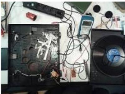
Der Plattenteller eines Sony „PS-LX250H“ Plattenspielers drehte sich nicht mehr. Die Fehlersuche ergab einen defekten Motortreiber. Auch in diesem Fall geht es weiter, sobald Ersatz besorgt wurde.
