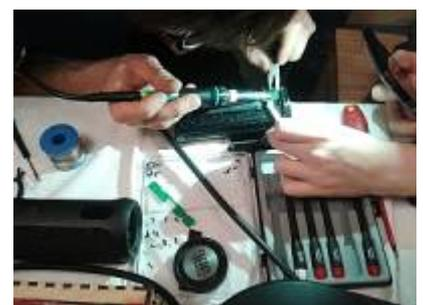
An einem JBL „Flip 3“ Bluetooth-Lautsprecher war die defekte Micro-USB-Ladebuchse zu tauschen. Da der Besitzer bereits ein passendes Ersatzteil mitgebracht hatte, eigentlich keine große Herausforderung. Trotzdem bedurfte es beim Löten bzw. Entlöten des filigranen Steckverbinders
