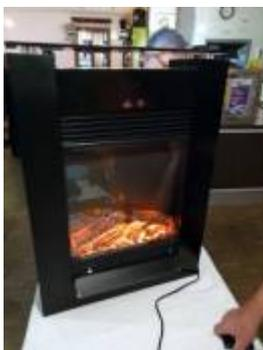
Ein schon größeres Teil, ein Elektrokamin „El Fuego TessinAY0627 / EF-25“, kam dann auf den Tisch. Der Einschalter mit Kontrolllampe rastete nicht mehr ein und kurz vorher hatte der Leitungsschutzschalter ausgelöst. Wir stellten einen Kurzschluss im Schalter zwischen L und N fest. Ohne die Kontrollleuchte hatten wir einen Schalter da und den haben wir dann auf Wunsch auch eingebaut.
