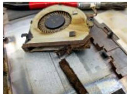
Ein Gaming-Laptop „ASUS FX 502V“ wurde zu uns gebracht, weil es draus gequalmt hatte. Der Test des Netzteils zeigte keinen Fehler. Wir öffneten das Laptop und stellten einen aufgeblasenen Akku und eine völlig verstopfte Lüftung fest. Da der Gast den Akkubetrieb nicht benötigt, wurde der Akku ausgebaut. Wir reinigten den gesamten Lüftungsweg. Der Laptop arbeitet nun wieder einwandfrei und es qualmte auch nichts mehr. Der Gast wird zu Hause den mehrstündigen Dauertest vornehmen.
