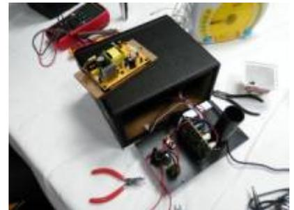
Die kabellose Bluetooth-Übertragung zu den Lautsprechern von Blaupunkt funktionierte nicht. Sie würde ja vielleicht funktionieren, aber bei der Betätigung des Einschalters tat sich gar nichts. Schuld war hier eine kalte Lötstelle genau an diesem Schalter. Nachdem sie nachgelötet wurde, klappte es wieder.
