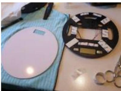
Nach einem halben Jahr der Benutzung hatte sich an der Küchenwaage „Ambiano“ die Glasplatte gelockert. Wir haben sie mit doppelseitigem Spiegelklebeband wieder befestigt.
