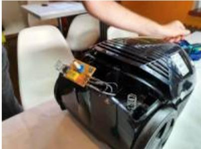
Los ging es mit einem 10 Jahre alten Staubsauger „EIO BS59“, der während seiner Arbeit einfach den Dienst verweigerte. Der Besucher hatte ihn zu Hause schon geöffnet, kam aber mit der Fehlersuche auf Grund fehlender Messtechnik nicht weiter. Den Fehler konnten wir dadurch sehr schnell finden – Kabelbruch im Knickschutz des Steckers. Den Konturenstecker wechselte der Besucher unter Anleitung dann selber.
