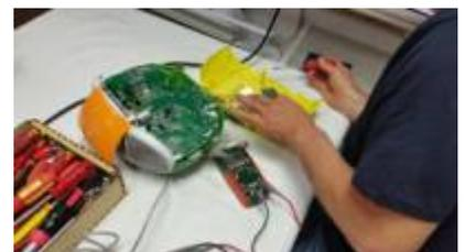
Einem Radiorecorder „Watson RR5873“ war leider nicht mehr zu helfen. Seine CD-Lasereinheit und sein Kassettendeck waren schon so stark beschädigt, dass keine Reparatur mehr möglich war.
