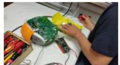
Einem Watson „RR5873“ Radiorecorder war leider nicht mehr zu helfen. Seine CD-Lasereinheit und sein Kassettendeck waren schon so stark beschädigt, dass keine Reparatur mehr möglich war.
